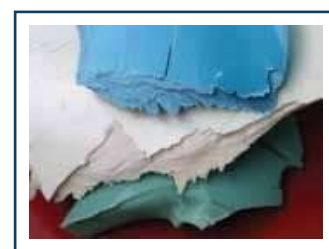
L'immagine mostra il PVC di struttura amorfa (colore verde) e il PVC di struttura lamellare ottenuta grazie al processo di orientazione molecolare (colore azzurro)
